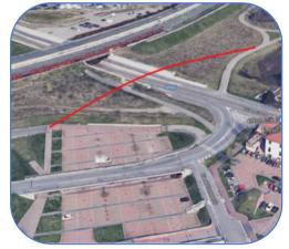
Realizzazione di una infrastruttura di connessione ciclopedonale tra il quadrante est ed il quadrante ovest del territorio del Comune di Baranzate, ad oggi separati da un'importante arteria viabilistica rappresentata dalla dalla via Milano (ex SS 233 Varesina). E' previsto un sovrappasso in carpenteria metallica, provvisto di rampe di adduzione su terrapieno piantumato ai lati est e ovest
