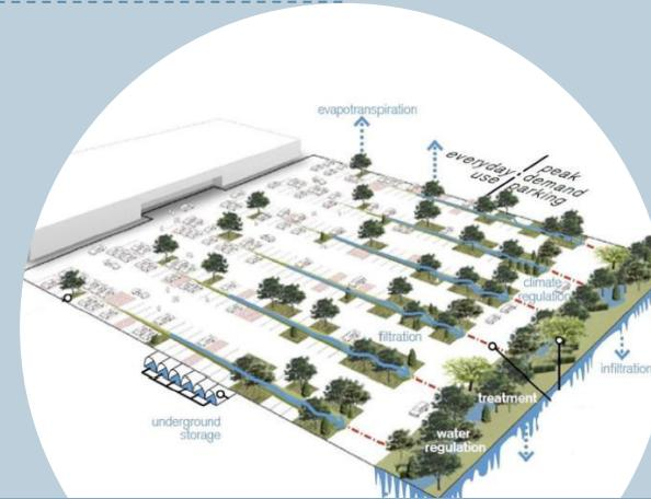
Intervento di disconnessione della rete del parcheggio della stazione, in via Carlo Alberto Dalla Chiesa, con realizzazione di sistemi di drenaggio urbano sostenibile. Le opere coniugano elementi gestionali/funzionali con opere di deimpermeabilizzazione del parcheggio migliorandone il valore estetico/paesaggistico dell'area
