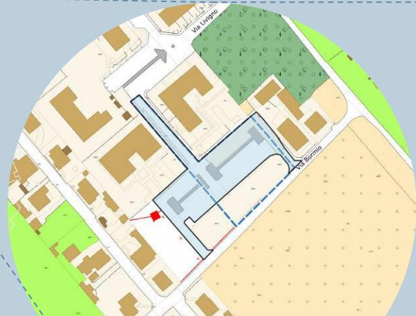
Riqualificazione del parcheggio di via Bormio con parziale eliminazione della pavimentazione esistente per creare nuove zone verdi e sostituzione della restante parte con pavimentazione permeabile.
