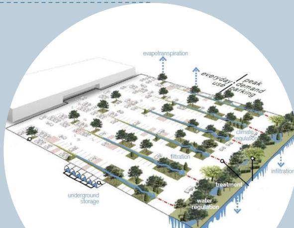
Riqualificazione del parcheggio di via Roma con parziale depavimentazione per creare nuove zone verdi e completa disconnessione dalla rete fognaria: le acque di pioggia saranno infiltrate nel suolo attraverso trincee drenanti e pozzi perdenti.
